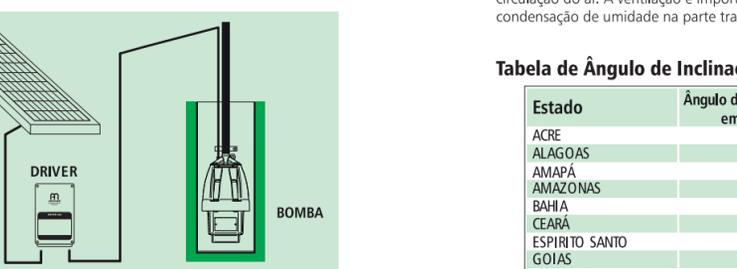
Para proteção da bomba e controle de nível em reservatório, instalar o **ANAUGER®** Sensor no circuito entre o Driver solar e a bomba, porém, adicionar à metragem de cabo necessário a ligação ao comprimento total do circuito.
