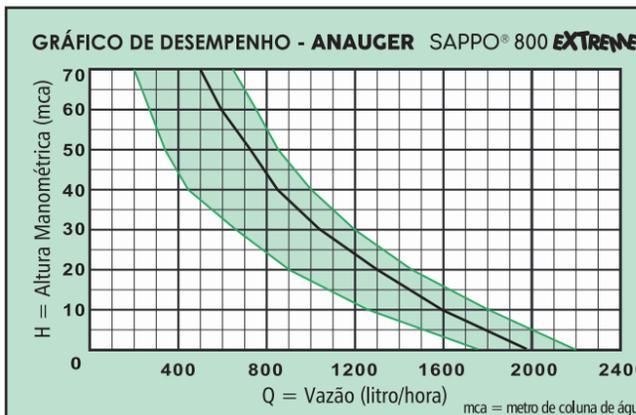
Obs.: A bomba permite uma variação de tensão nominal de ±5%, porém com interferência direta na sua vazão.
