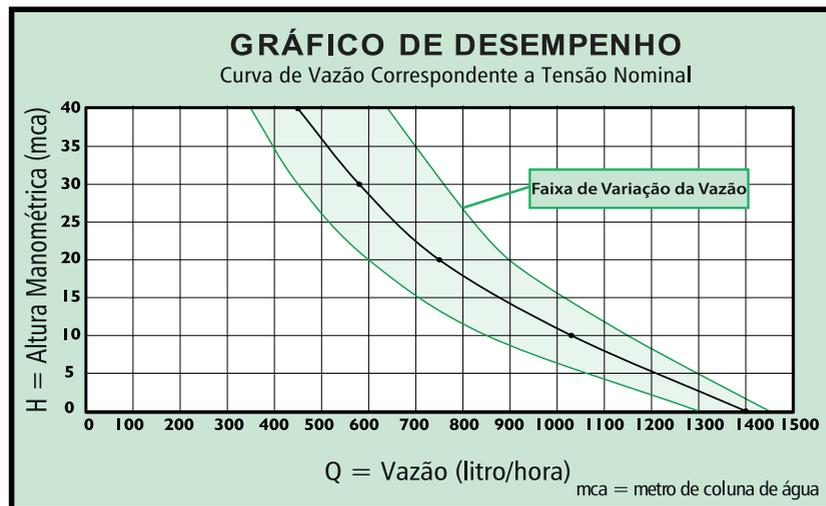
Obs.: A bomba permite uma variação de tensão nominal de  $\pm 5\%$ , porém com interferência direta na sua vazão.
