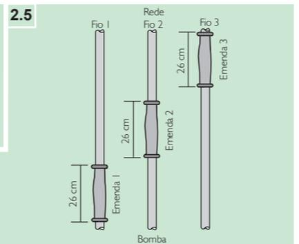
Todas as emendas entre os fios da bomba e os da rede elétrica, bem como as emendas dos eletrodos de nível localizados dentro do poço, deverão ser à prova d'água, atender aos requisitos da NBR9513 e ser estanque a submersão permanente de 20 metros.
