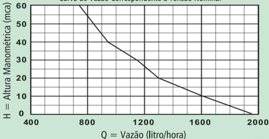
Obs.: A bomba permite uma variação de tensão nominal de  $\pm 5\%$ , porém com interferência direta na sua vazão.
