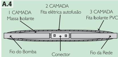
Detalhe em corte da emenda completa.
