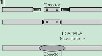
Utilizar conector metálico de compressão para unir as extremidades. Aplicar uma camada de massa isolante.
