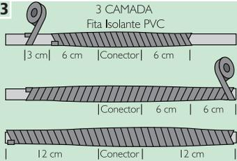
Aplicar 3 camadas com a fita isolante PVC, tracionar a mesma de forma adequada.
