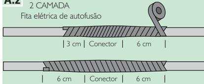
Aplicar 2 camadas com a fita elétrica de autofusão, tracionar a mesma de forma adequada.
