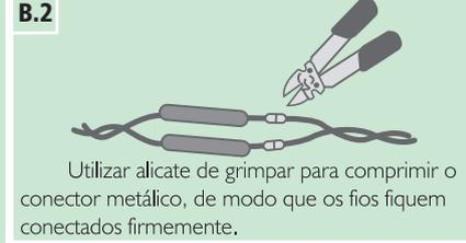
Utilizar alicate de grimpar para comprimir o conector metálico, de modo que os fios fiquem conectados firmemente.
