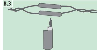
Centralizar o tubo termocontrátil sobre o conector metálico e aquecer com uma fonte de calor (soprador de ar quente ou isqueiro comum).
